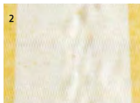
Wickelfalten in der Mitte der Tuchbahn Winding creases in the centre of the awning fabric
