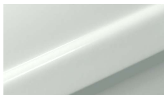
RAL 9016 (Verkehrsweiß) Pulverbeschichtung mit seidenglänzend glatter Oberfläche
